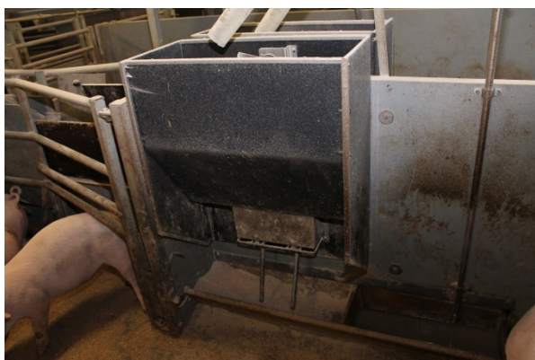
Figur 9. Den modificerede Domino S22 med forlængede "uddoseringspinde". Herved kunne det undgås at grise kunne komme i klemme mellem "pinde" og stiafskillelse
