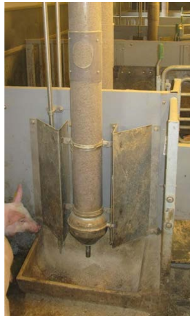
Figur 8. Over røret sidder volumendosereren der bruges i diegivningsperioden. Her ses udfodringsenheden med påmonteret pendul, der bruges efter fravæning
